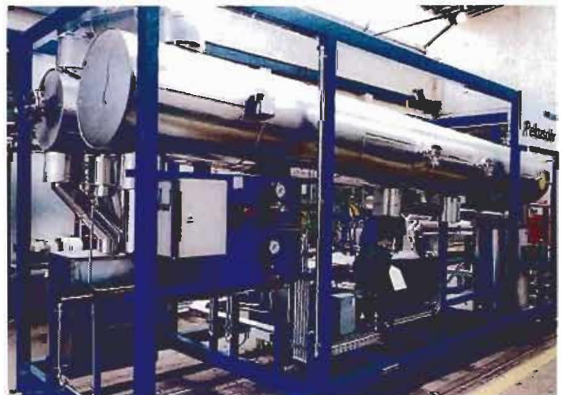
Bild 1: Kryokondensationsanlage für die Reinigung eines Abluftstroms von 200 m 3 /h. Messer hat mehr als 30 Anlagen zur Reinigung von Abluftströmen aus Chemie- und Recyclinganlagen mit solchen Anlagemodulen aufgebaut.
