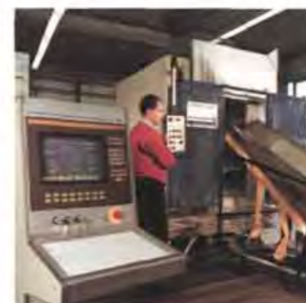
Fast 200 Entgratungsprogramme können gespeichert und weitere von externen Datenträgern eingelesen werden. Auch die Chargier- und Fördereinrichtung läßt sich in die Prozeßsteuerung einbeziehen.
