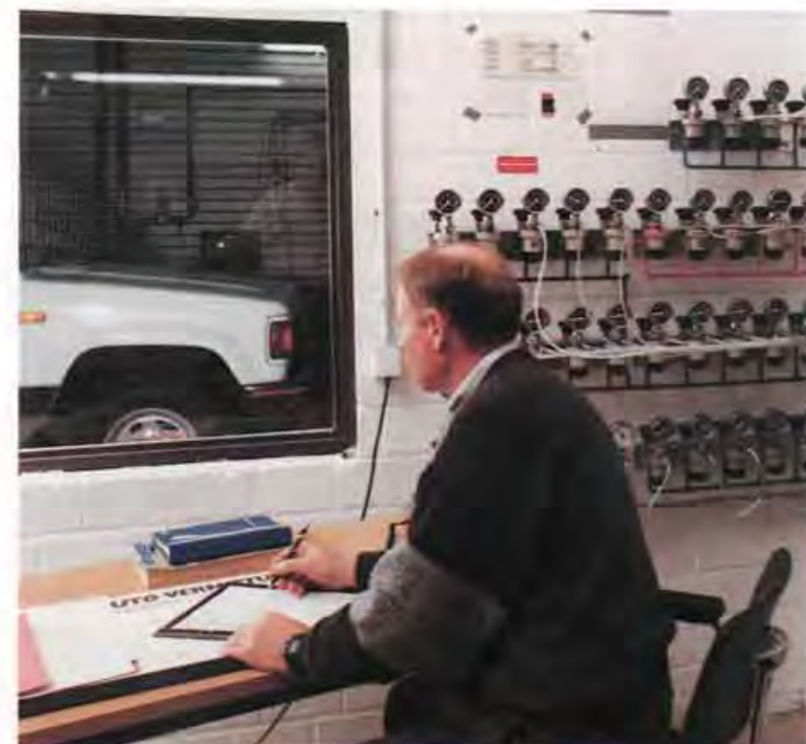
TÜV-Abgas-Prüfstände werden mit Reinstgas-Versorgungsanlagen ausgestattet.
