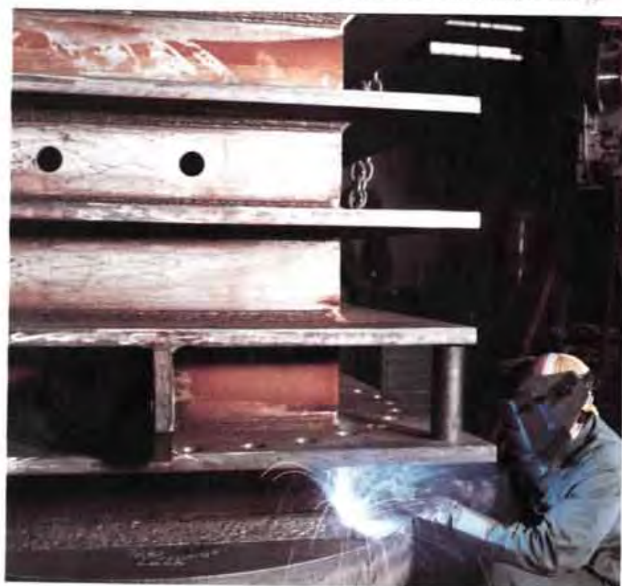
Fülldrahtelektroden gewinnen durch hohe Schweißqualität und Wirtschaftlichkeit an Bedeutung, zum Beispiel beim Mehrlagerschweißen hochlegierter Stähle an einem Fahrmischer.
