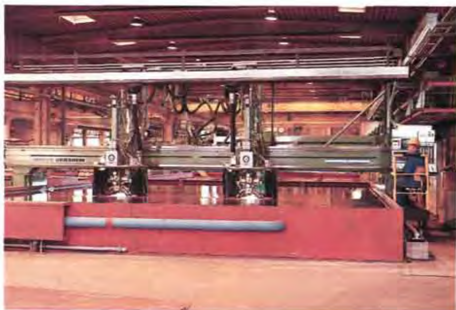
Das unterwasser-Plasma-schneiden, das besonders häufig im Schiffbau verwendet wird, schonkt die Umwelt, indem es Schadstoffe im Wasser bindet und Lärm schlicht
