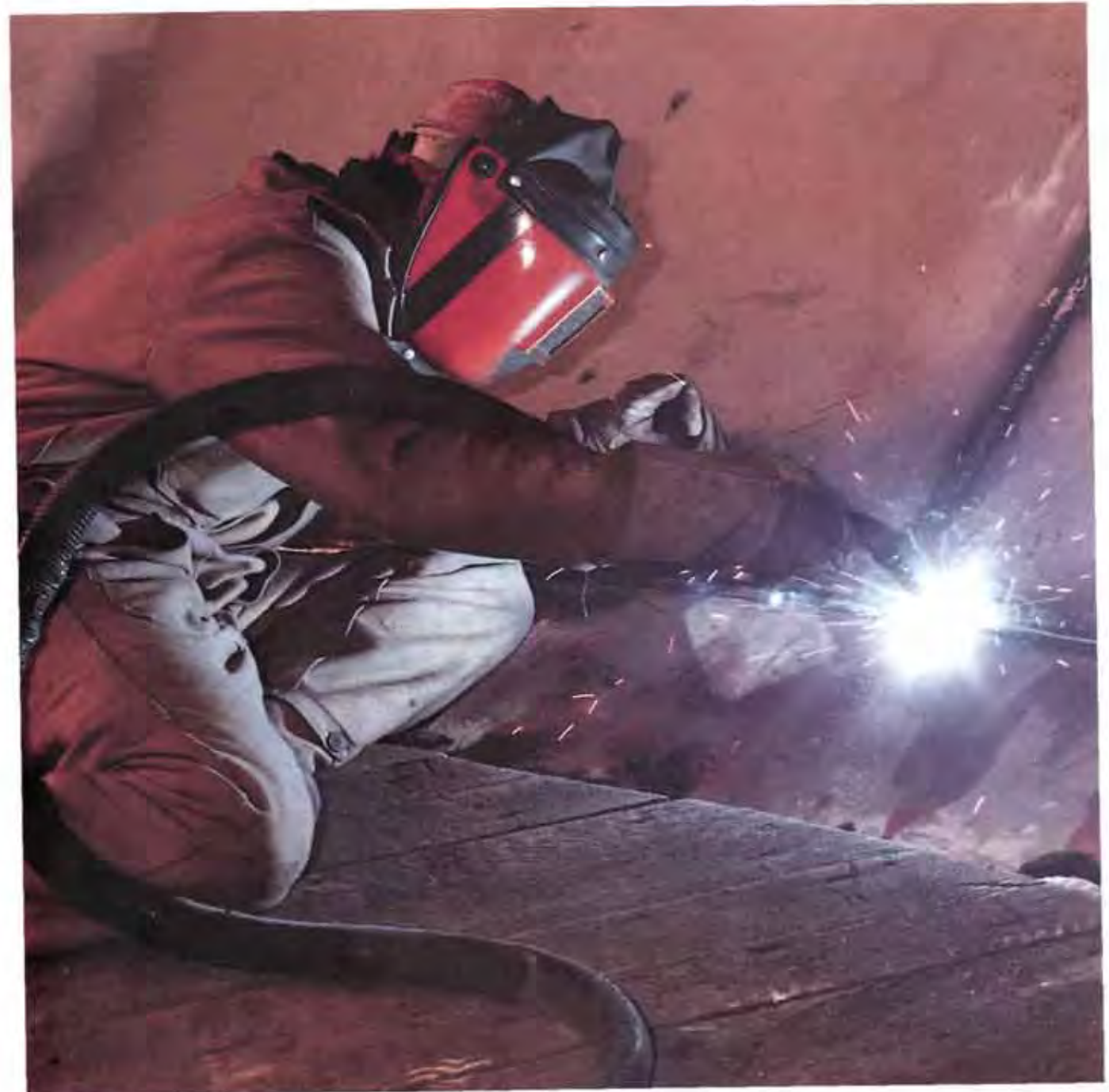
Auf die Vielseitigkeit und Wirtschaftlichkeit des MAG-Schweißens kann bei vielen Fügeaufgaben nicht verzichtet werden, zum Beispiel bei der Fertigung eines Feuerlöschgastanks aus Chromnickelstahl für ein Tankschiff.
