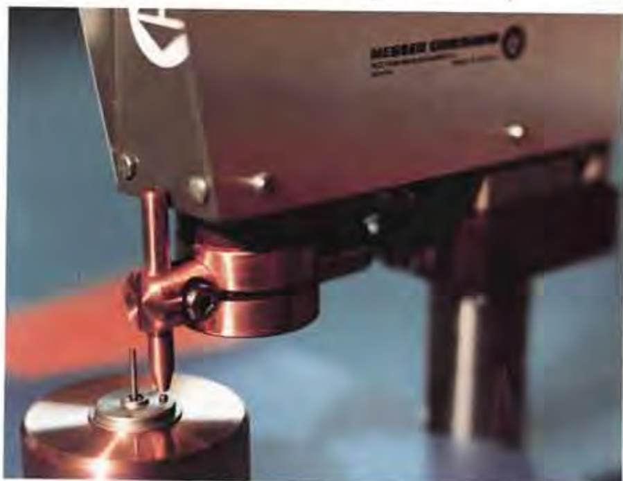
Bei der Fertigung eines elektronischen Feilendruck-Kontrollsystems tragen Mikroschweißungen zur Verkehrssicherheit bei
