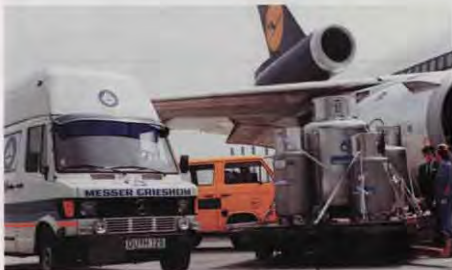
Superisolierte Transportbehälter sind nach internationalen Verkehrs- und Transportvorschriften ausgelegt und TÜV-geprüft. So können auch verflüssigte Gase wie Helium per Luftfracht nach Übersee versandt werden.
