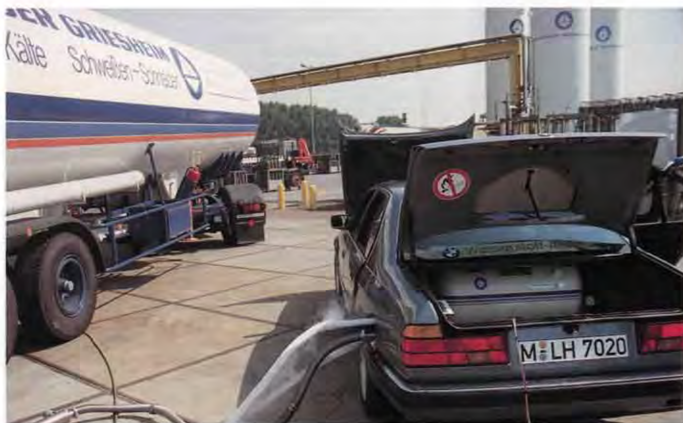
Das Betanken von Versuchsfahrzeugen mit flüssigem Wasserstoff – hier aus einem 40.000-Liter-Transporttank – ist heute schon Routine. Unser Know-how über Handhabung und Speicherung des tiefkalten Mediums trägt dazu bei, die Praxis für den Fall zu erproben, daß Wasserstoff wirtschaftlich als Energieträger der Zukunft Anwendung findet.
