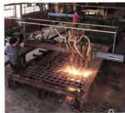
Brennschneidmaschinen sind gefragte Produkte bei unserer südafrikanischen Beteiligung Fedgas. Bei einem Stahlverarbeiter sind acht Maschinen in Betrieb
