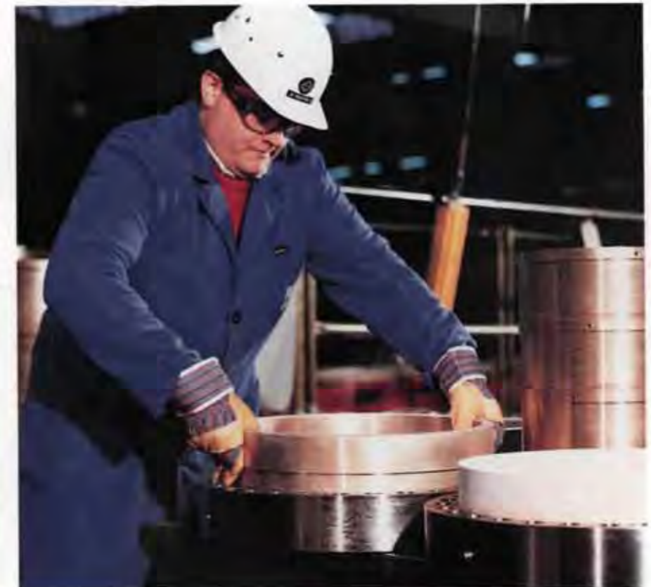
Ein aktuelles Beispiel aus der industriellen Fertigung von Hydraulikpressen ist das Kaltdehnen von Führungsbuchsen aus Messing, die mit Stahlzylindern verbunden werden
