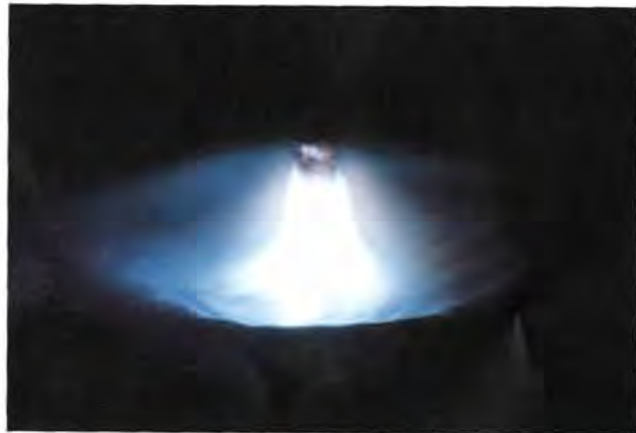
Video-Projektion macht den Werkstoffübergang beim MAG-Schweißen mit einer hochlegierten Fülldrahtelektrode und einem neu entwickelten Mischgas in einer Makroaufnahme sichtbar.
