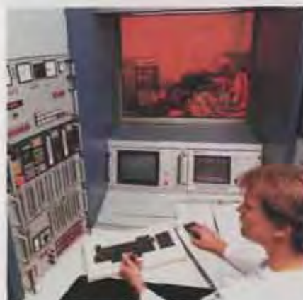
Schadstoffarme BMW-Motoren auf dem Prüfstand: Die Abgasanalysen-Anlagen werden mit Prüfgasen geeicht, die Abgaskomponenten analysiert und die Werte für die Motoren optimiert
