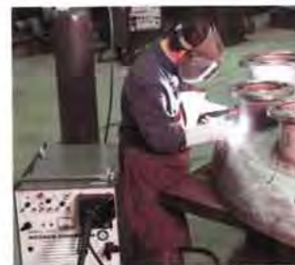
Für die Verbindung eines Behälterbodens aus Chromnickelstahl mit Stützen werden Wurzellagen im WIG-Verfahren eingeschweißt
