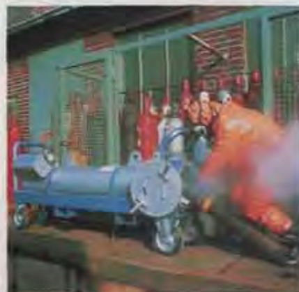
Eine besondere Dienstleistung ist die Entsorgung von Gasresten in Stahlflaschen oder von defekten Flaschen mit einem Bergungsbehälter
