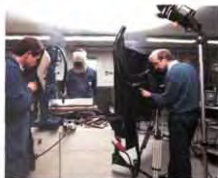
Video-Projektion macht den Werkstoffübergang beim MAG-Schweißen mit einer hochlegierten Fülldrahtelektrode und einem neu entwickelten Mischgas in einer Makroaufnahme sichtbar.
