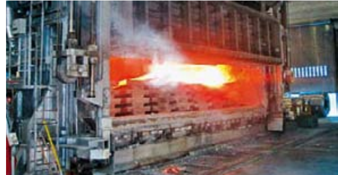
In einem Schmelzofen wird Aluminiumschrott geschmolzen.
