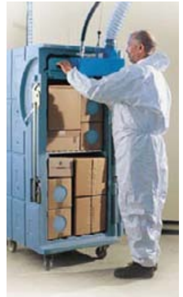
Der Kopf des Siber-Containers wird mit Trockeneisschnee gefüllt.
