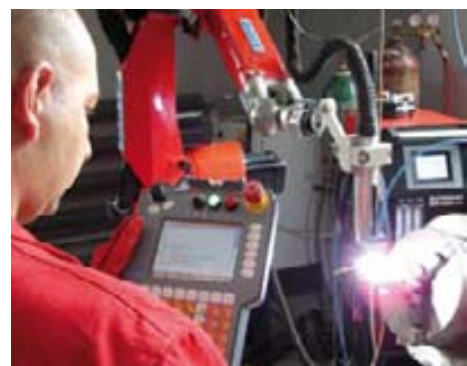
Das Plasma-Pulver-Auftragsschweißen erfolgt computergesteuert.
