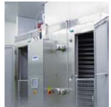
In solchen Schränken wird das frisch verarbeitete Fleisch mit Stickstoff gefrostet.
