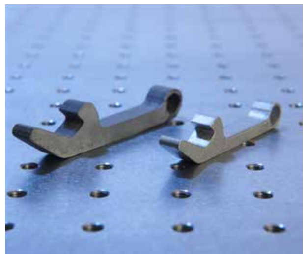
Binder Jetting (links: Grünling, rechts: fertiges Bauteil)
