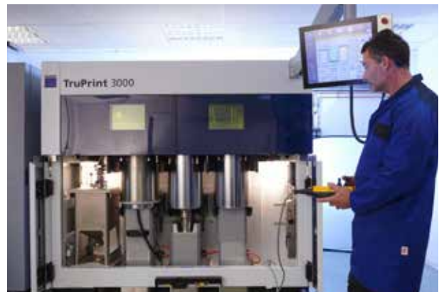
Pulverwechsel unter Schutzgasatmosphäre, durchgeführt am ifw Jena
