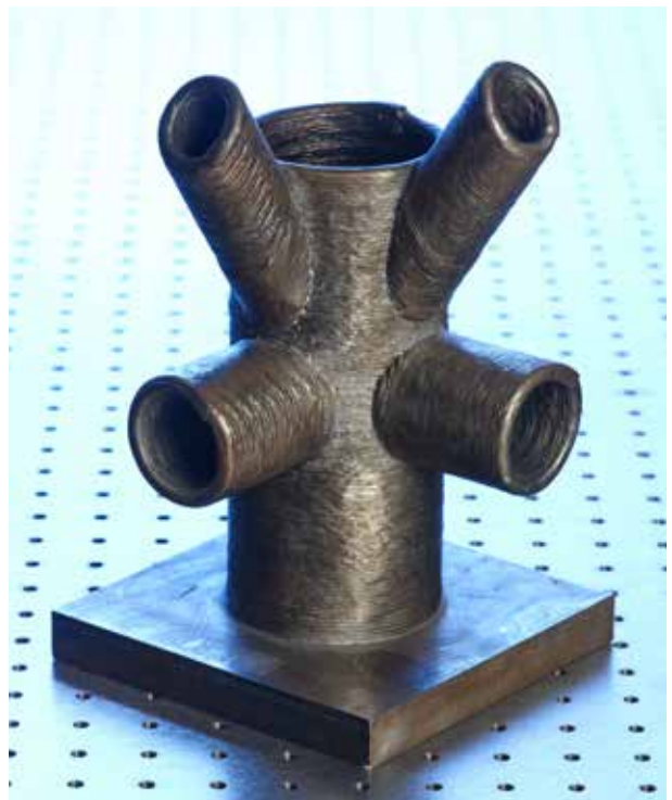
Knotenpunkt aus dem Stahlbau, produziert von der TU Ilmenau
