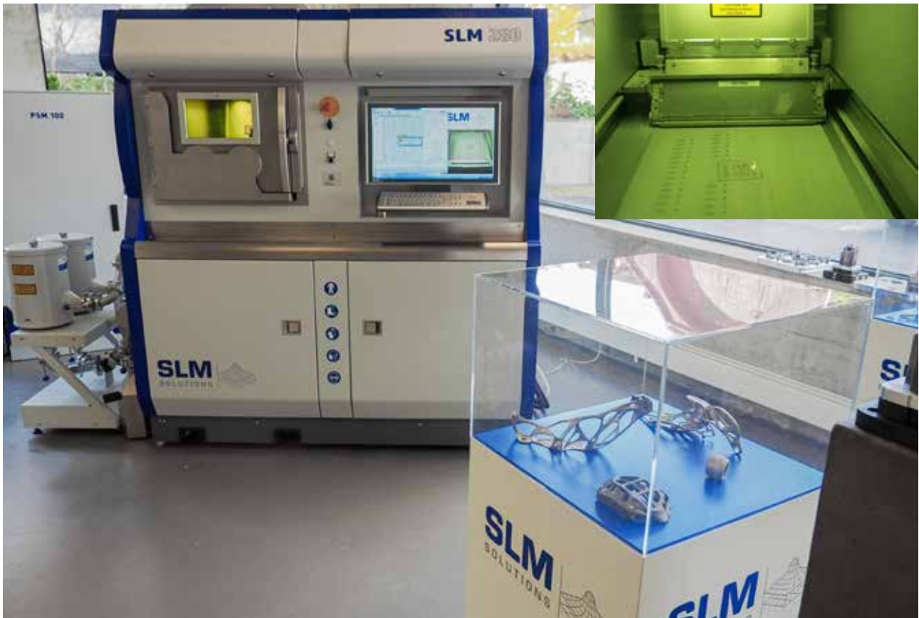
Muster, produziert mit SLM®280 inklusive Blick in die Prozesskammer bei der URMA AG in Ruppertsuil
