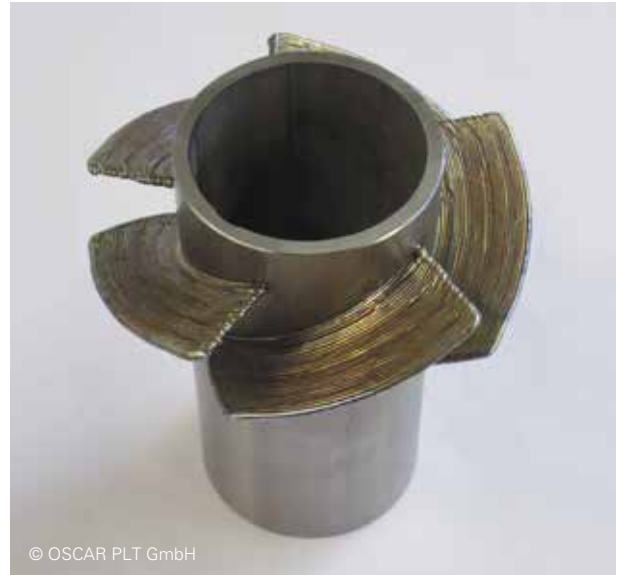
Koaxiales Laser-Metallauftragen mit Draht
