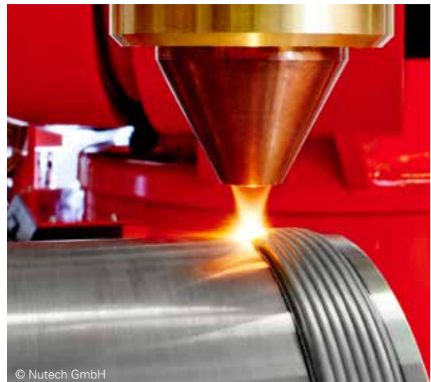
Laser Metallauftragen mit Pulver
