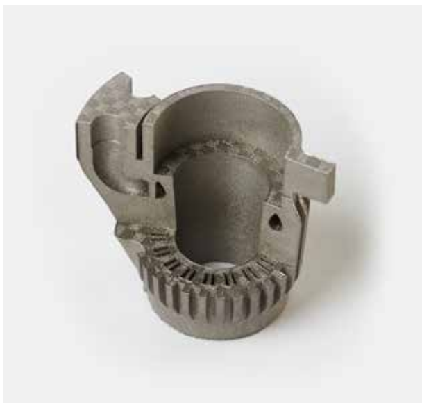
Gekühlte Schweissdüse aus CrNi-Stahl, entwickelt von ifw Jena
