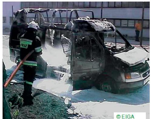
Une fuite de gaz acétylène provenant du robinet d'une bouteille de gaz s'est enflammée à l'intérieur d'un camion de livraison. Le conducteur s'est échappé de justesse. Le véhicule a brûlé en seulement deux minutes.
