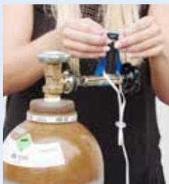
Ouvrez le robinet de la bouteille (lentement!) et vérifiez s'il y a des fuites au niveau du raccord.
