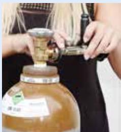
Empêchez la bouteille de tomber, dévissez le bouchon de la bouteille. Vissez la vanne de remplissage sur le robinet de la bouteille à la main uniquement (n'utilisez aucun outil!).
