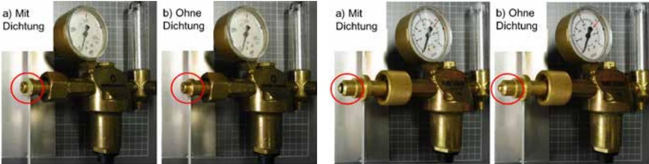
Abb. 2: Dichtung am Druckminderer / lks: 200 bar / rechts 300 bar
