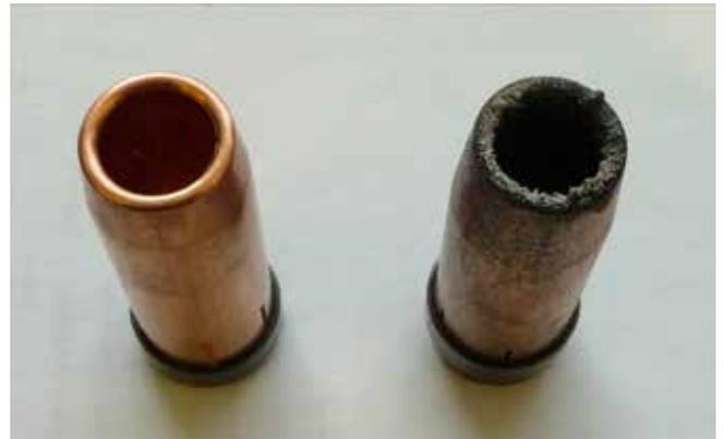
Abb. 5: Schutzgasdüse
